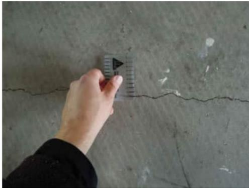
1.5 CRACK UP TO 1MM PERPENDICULAR TO THE CRACKS BETWEEN GRID C COLUMNS
